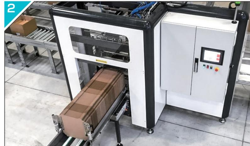
2 内容品を段ボールパッドで固定するためのシステムです。内容品の形状に合わせて段ボールパッドが変形するためしっかり固定できます。
