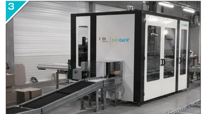
3 Form'it! で組み立てたケースの中に入れられた内容品の高さを自動で測定し、外装ケースを最適な高さに加工します。内容品に応じて本体ケースの高さ寸法を最適な高さに自動調整し、蓋をかぶせて封緘します。
