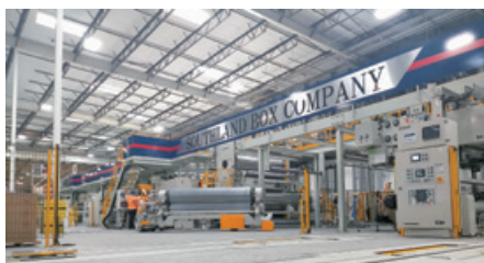
サウスランドボックス社に設置された最新鋭の貼合機「TM450」
